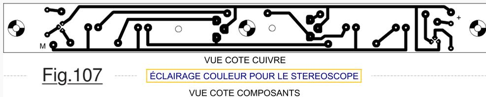
La Fig.107 nous présente le routage du circuit imprimé qu'il faut réaliser. Dans le répertoire <DESSINS TECHNIQUES>, le fichier **CIRCUIT IMPRIME ECLAIREGE COULEUR.bmp** nous fournit au format BMP le tracé à l'échelle du routage et de l'implantation des composants comme c'était déjà le cas pour le circuit d'éclairage blanc. Les dimensions du circuit sont de 245mm x 24mm. La photographie
