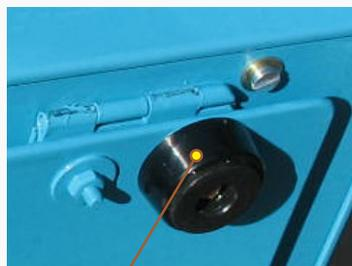
Pied en caoutchouc pour réaliser l'assise du stéréoscope quand la béquille est totalement rétractée sur le dessous.
